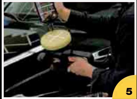
Vor der ersten Benutzung wird der neue Polierschwamm mit Ultimate Quik Detailer angefeuchtet. Nun wird die Politur X-förmig auf den Polierschwamm aufgetragen. **(Bild 4 + 5)**
